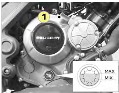
1. Tampa de enchimento de óleo de motor.
