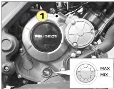
1. Tapon de llenado del aceite motor.
